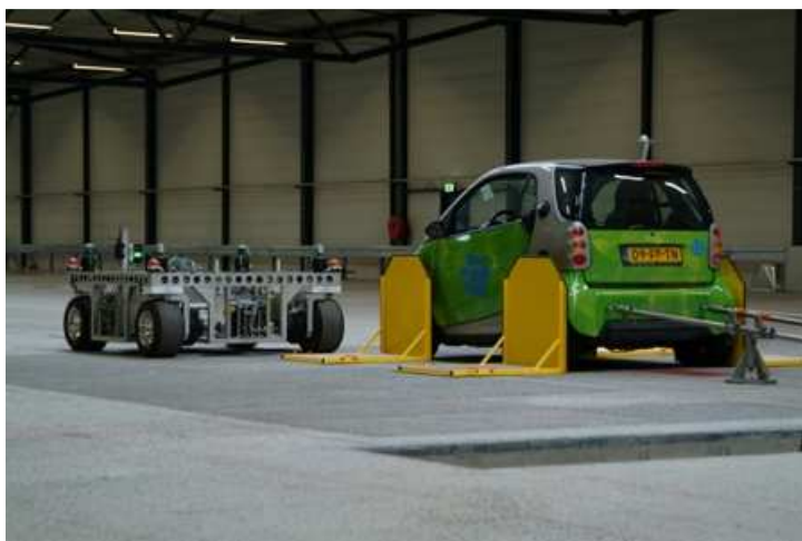
Figuur 8: VEHIL: Hardware-in-the-loop voertuig testfaciliteit in Helmond [Driessen et al., 2007]
