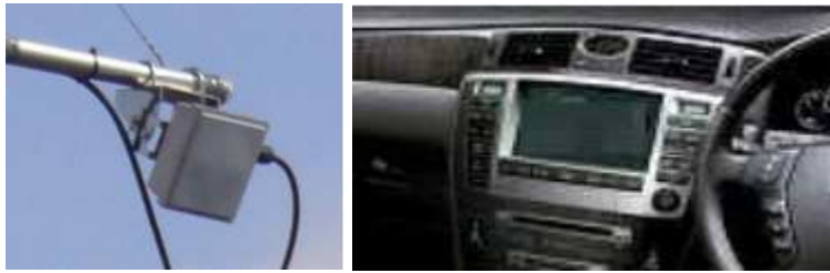
Figuur 28: ITS Spot (links) en voorbeeld van een bijbehorende OBU (rechts). Bron: mlit.go.jp
